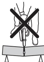
Si la lame se pince ou se coince dans la zone de rebond, la force de réaction va pousser la découpeuse vers le haut, puis la faire retomber en direction de l'utilisateur dans un mouvement de rotation qui peut causer des blessures sérieuses, voire mortelles. Faites attention aux éventuels mouvements de la pièce à travailler. Si la pièce à travailler n'est pas correctement soutenue et qu'elle se décale lors de la découpe, elle risque de pincer la lame et d'entraîner un rebond.
