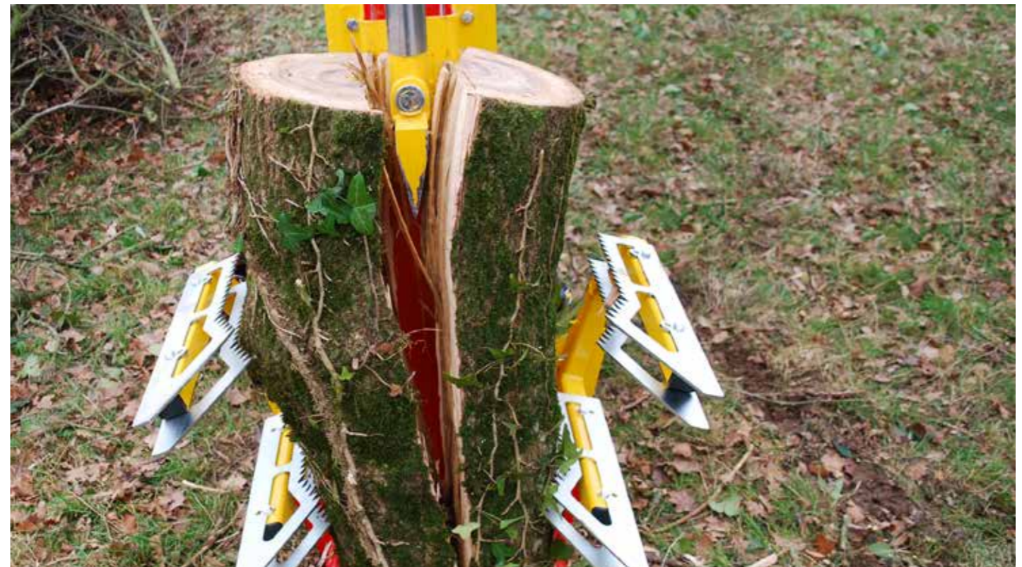
Lève-bûches de série grâce à une chaîne reliée au coin
